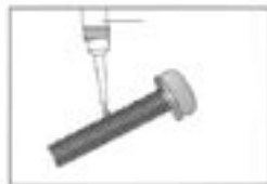
Смажьте винты анаэробным клеем
